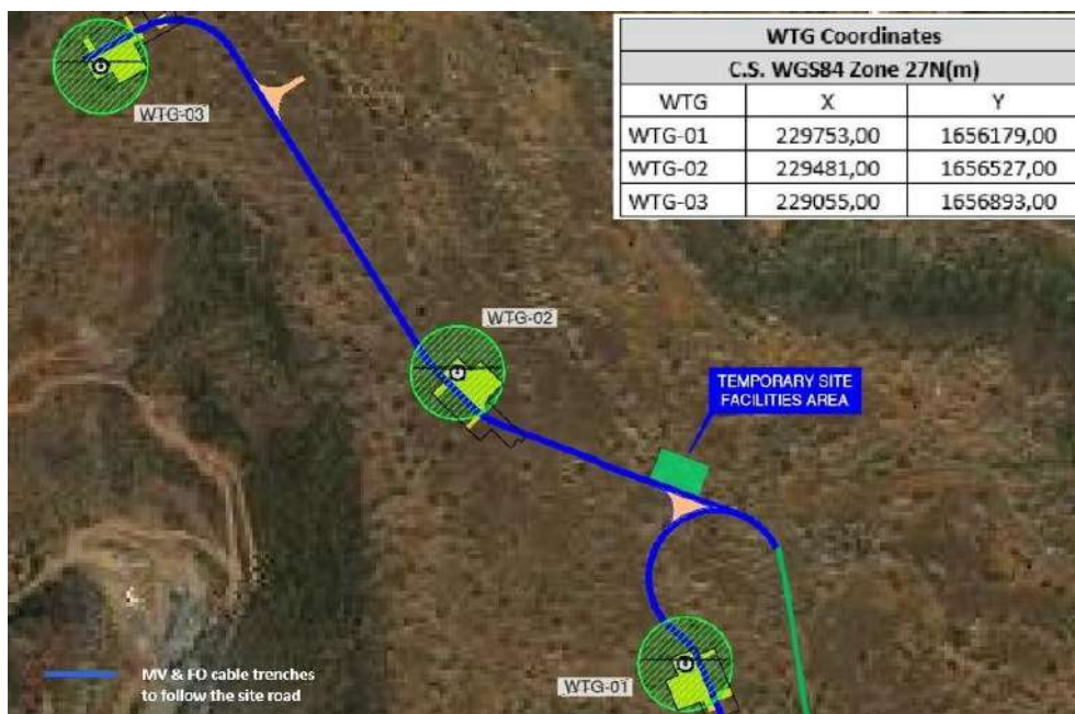
Figura 2-12 Cabo a ser colocado no subsolo entre os WTGs 01, 02 e 03
