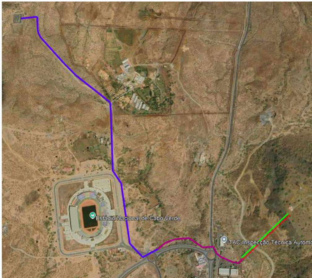
Figura 2-16 Rede subterrânea de 20 kV existente (roxo e magenta) em Santiago e segmentos aéreos (verde novo / vermelho existente)
