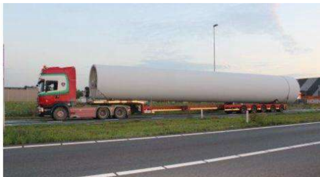
Figura 2-20 Exemplo de transporte de um segmento de torre
